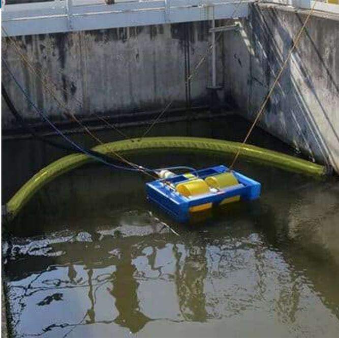
FlexiBelt es un brazo de contención flotante cargado por resorte único diseñado para ser utilizado por barcos durante las operaciones de repostaje y transferencia de productos. Subirá y bajará contra el casco y el malecón de los barcos, ajustándose automáticamente a las distancias y la línea de flotación cambiantes. Por lo general, se implementan dos FlexiBelts, uno aguas arriba y otros aguas abajo (orientados en direcciones opuestas).
